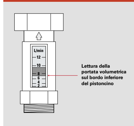
Fig. B.3.1-12 Lettura dell'indicatore di portata
