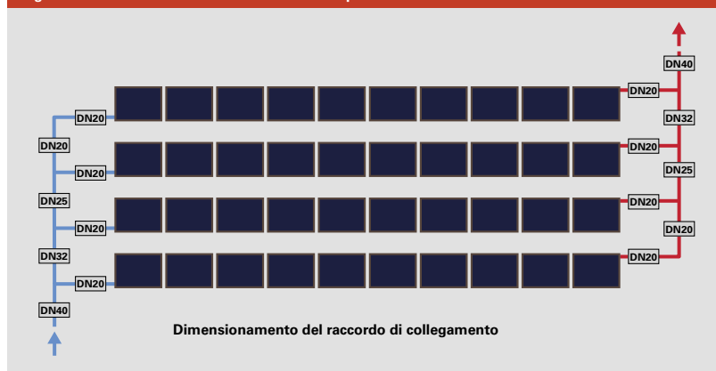
Fig. C.1.2-6 Velocità del fluido nei sottocampi
